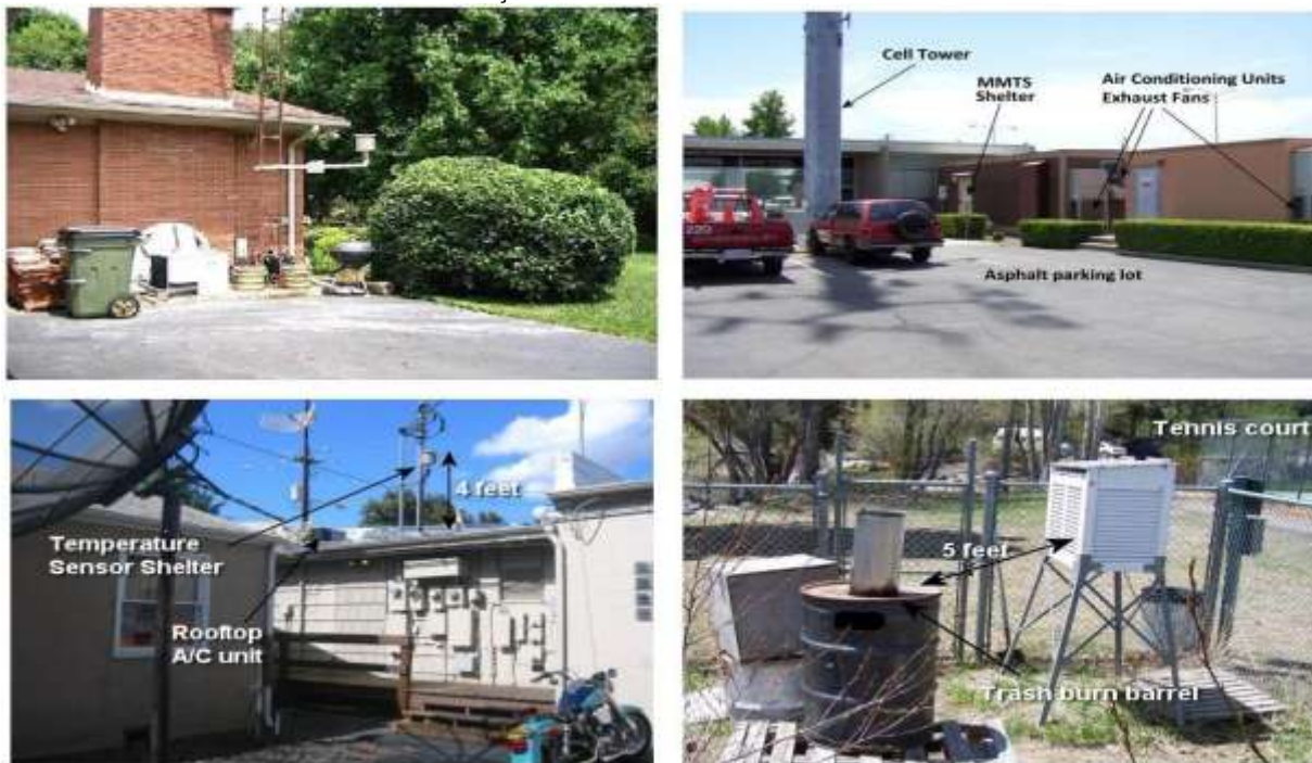
Figura 4. Localização de estações meteorológicas de superfície, em áreas urbanas, que não respeitam as condições mínimas de funcionamento.
